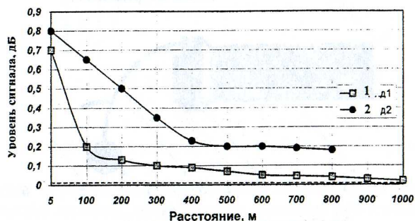
Рис. 14 Графические зависимости уровней сигнала акустического излучателя «Корюшка» от расстояния:
