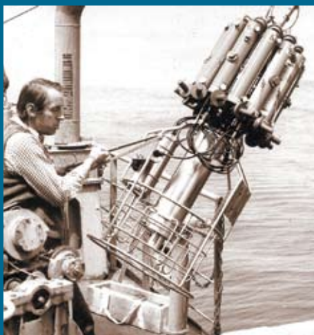
Забортные работы с зондом «Mark-3B» с кассетой батометров (у прибора С.И. Столярский, РТМ-С «Возрождение», 1986 г.)
