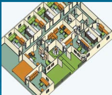
План размещения исследовательского блока на палубе рыбцеха рыболовно-поискового судна на основе проекта 05025РПМ
