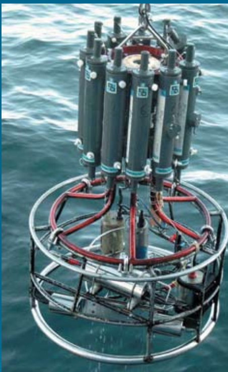
Зонд «ГРАП-7А», закрепленный на STD-комплексе с кассетой батометров
