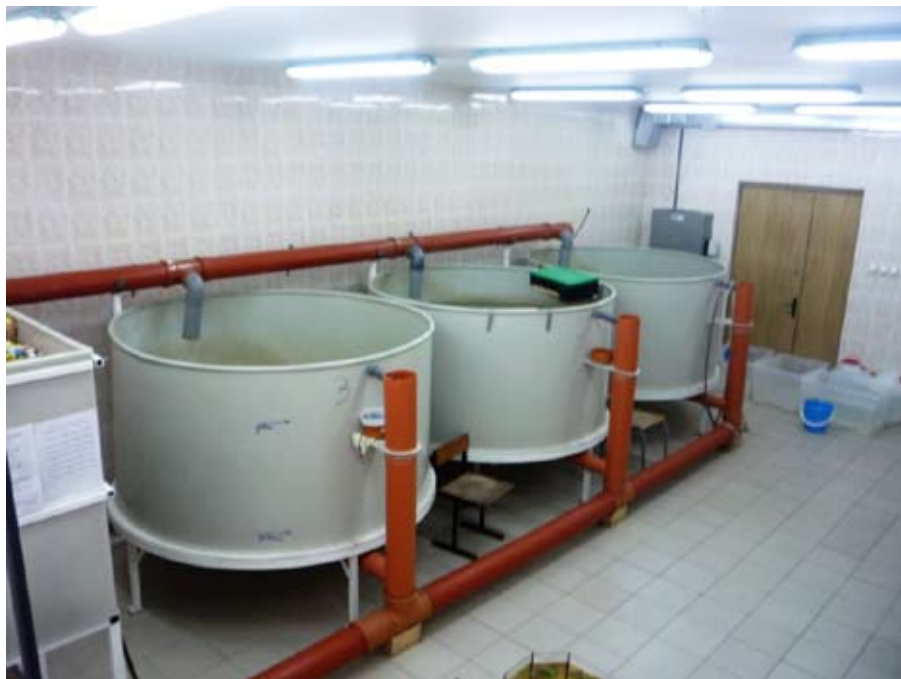
Рисунок 1. Экспериментальный модуль УЗВ для выращивания стерляди
