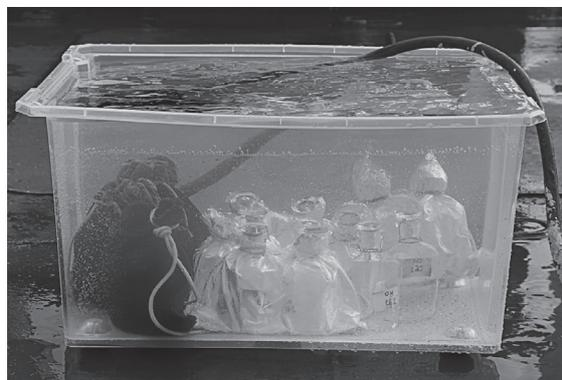
Рис. 2. Экспозиция склянок для измерения ПП фитопланктона на разрезе «Кольский меридиан», Баренцево море
